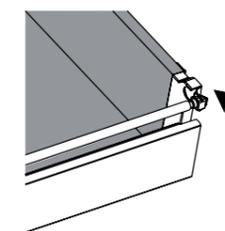
3. Die Reling in die Muffe drücken und die Abdeckung aufschieben.
