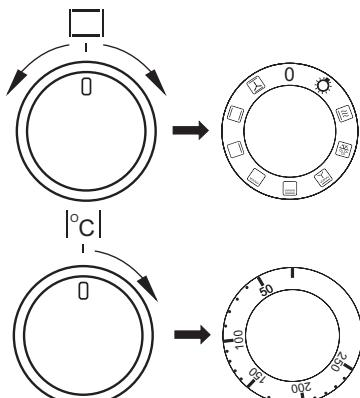
Beim Ausschalten des Geräts sind beide Schalter auf die „●“/„0“-Position zu drehen.
