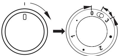
Bei einer Schalterstellung von „0 ● 1 ● 2 ● 3“ ist die innere Kochfläche in Betrieb und die Wärmemenge für das Kochgeschirr ist leicht regulierbar. Kurzes Drehen des Schalters auf die Position –○ schaltet die äußere Kochfläche ein. Ab jetzt lässt sich die Wärmemenge von beiden Kochflächen leicht regulieren, denn der innere Schalter wird beide Kochflächen erst nach Rückstellung des Reglers auf die 0-Position abschalten.
